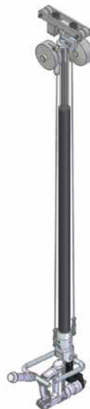
DMFi 600 con freno e mano di presa speciale per avvitatore a pistola
