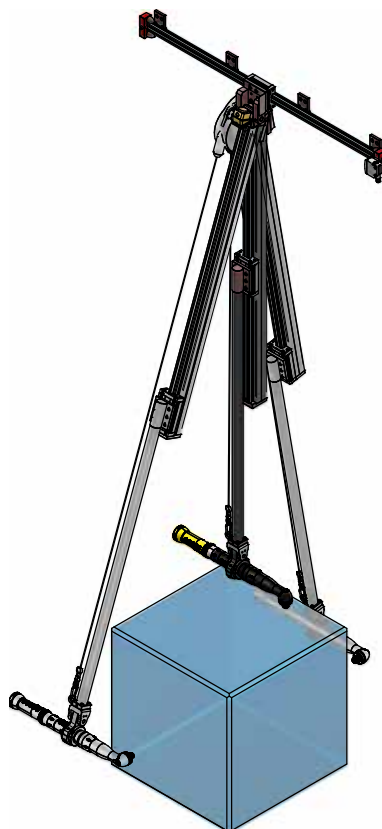
SLIDER 50 PC compatto con inclinometro e programmatore laser su binario orizzontale
